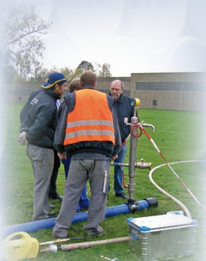
EVV-Druckprobenkoffer DPK III im Einsatz bei den Städtischen Werken in Kassel
