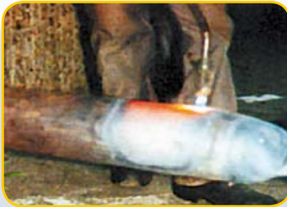
Rohr „kirschrot“ vorwärmen ...
