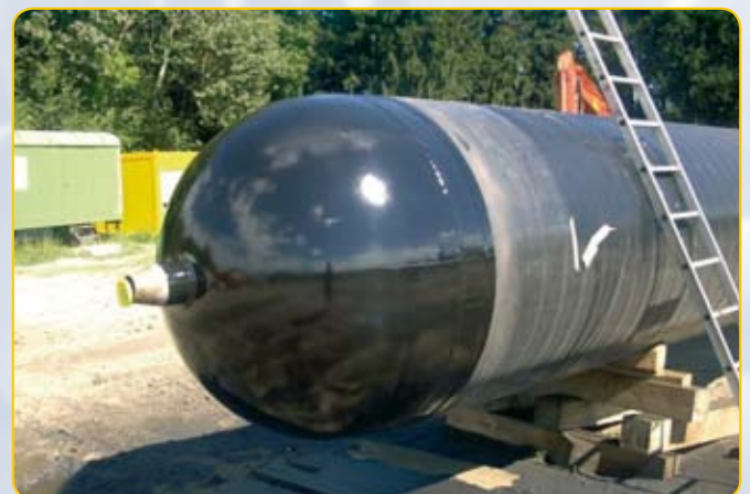
Polyurethan-Heißspritzbeschichtung für die Umhüllung kompliziert geformter Bauteile sowie großer Flächen im Neubau
