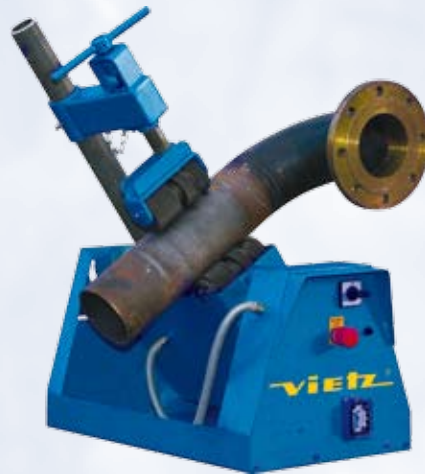
Spann-, Dreh- und Kippvorrichtung Typ U 150, Ausführung B
